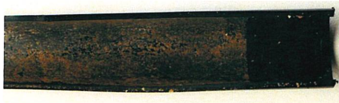
Vue en coupe d'un tube d'irrigation après injection du Mexel® Irrigation durant 45 jours.
