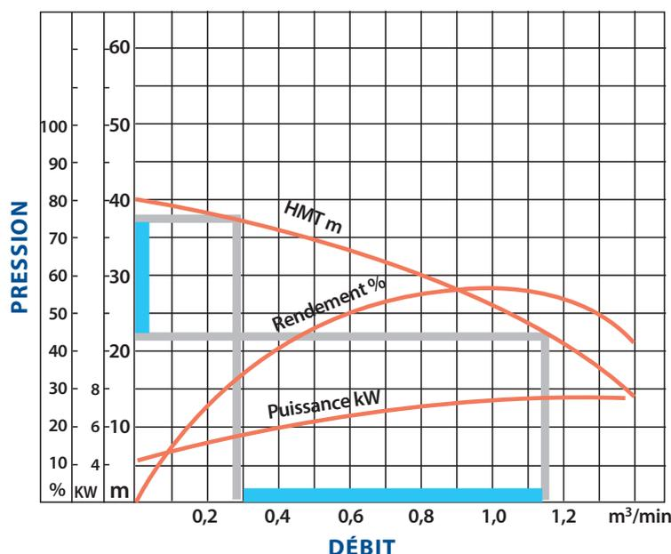
Une pompe qui fonctionne complètement à gauche ou complètement à droite de sa courbe est dans son plus mauvais rendement. De ce fait le moteur électrique va "forcer" et chauffer. La durée de vie de ce dernier va être extrêmement diminuée et il va se détériorer rapidement.
