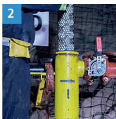
2 Insérez le panier dans le dispositif de traitement des boues
